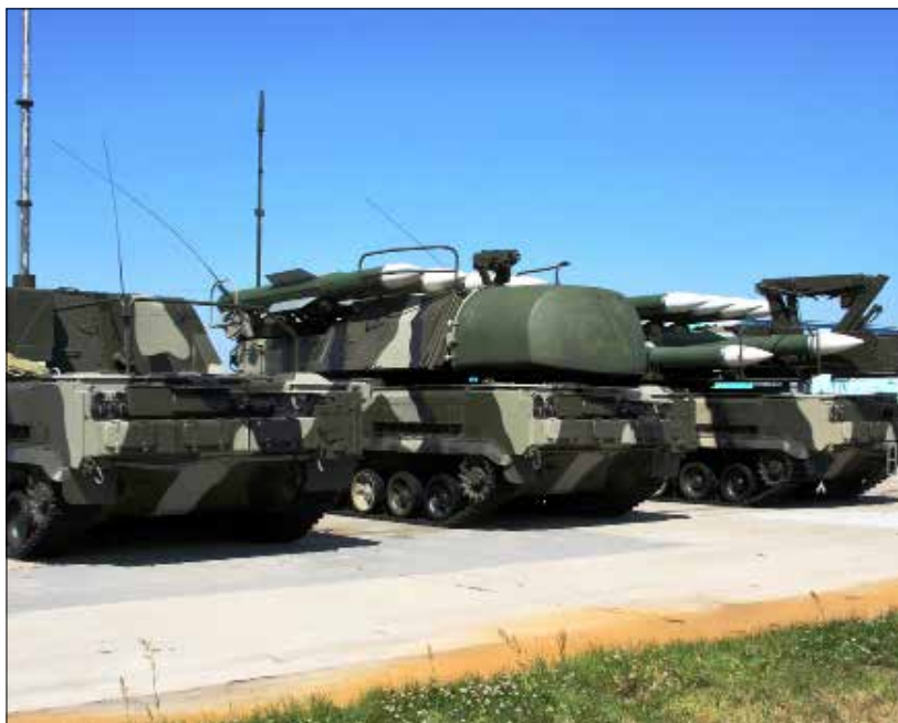
عناصر بطارية الـ«بوك»، من يسار الصورة إلى يمينها: عربة القيادة، عربة فتاك، وعربة التلقيم
